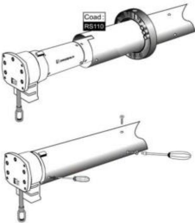
در این مرحله نوبت به جایگذاری موتور داخل درام رسیده است از آنجا که موتور یک قطعه الکترونیکی میباشد اتصال آن به درام می‌باشد با دقیقت و مراقبت انجام شود، از آنجا که تمام عملیات مربوط به درام جهت آماده سازی قبل از انجام رسیده است اکنون می‌باشد موتور را در داخل بصورتی قرار دهیم که:
